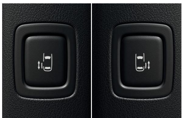
Кнопки электропривода сдвижных дверей
